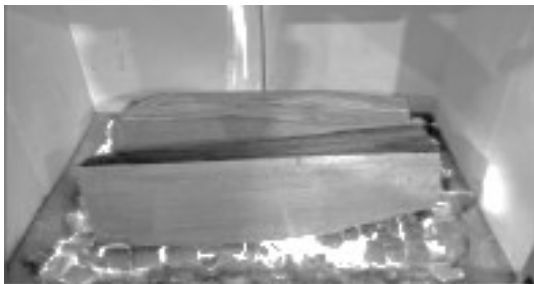
Abb. 4.2.2 Holzaufgabeart bei Nennwärmeleistung und verwendete Verbrennungslufteinstellung bei der Normprüfung
