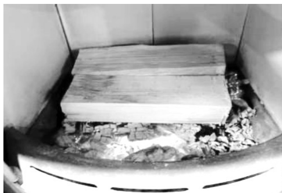
Abb. 5.2.2 Holzaufgabeart bei Nennwärmeleistung
