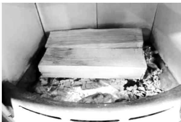
Abb. 5.2.2 Holzaufgabeart bei Nennwärmeleistung und Einstellungen Primärluft, Sekundärluft bei Normprüfung
